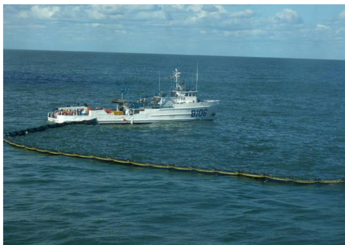
Supply tendiendo barrera de contención mecánica
