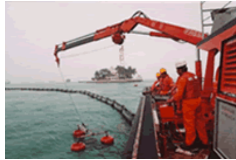
Barreras flotantes y aspiradores (skimmers) similares a los usados por el SISA y SIPA
